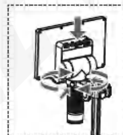
Montare la staffa per bloccare e fissare il microscopio.
